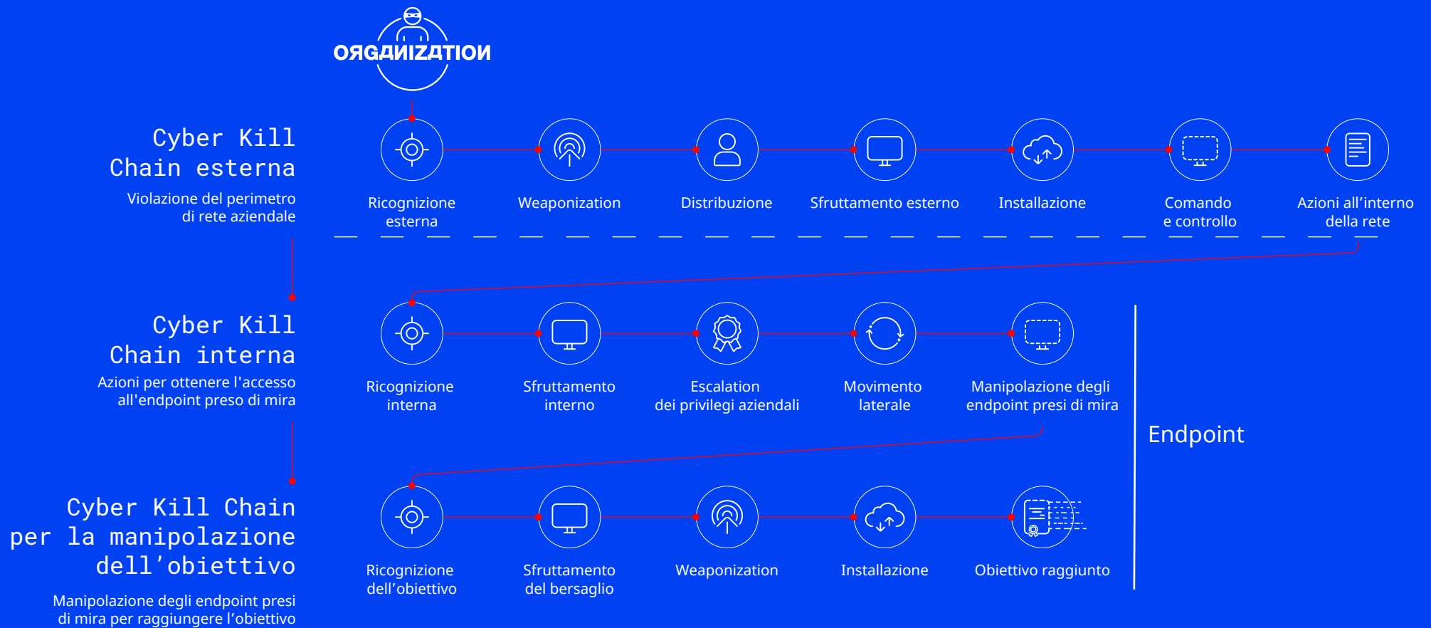
Figura 1. La Cyber Kill Chain estesa. Azioni per ottenere l'accesso all'endpoint preso di mira e manipolazione dell'endpoint per raggiungere l'obiettivo dell'aggressore.
